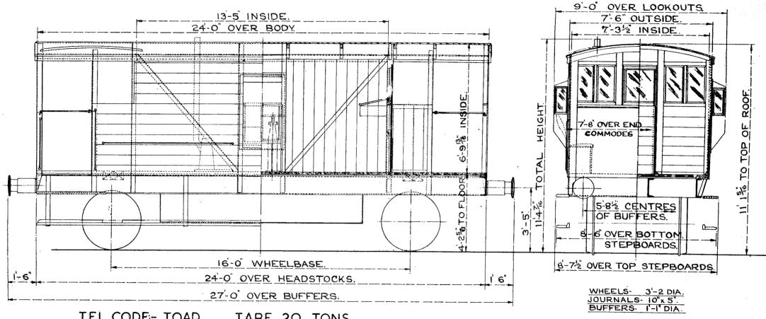
TEL CODE- TOAD. TARE 20 TONS. MIN. CURVE 12 CHAIN. SCREW BRAKE.
