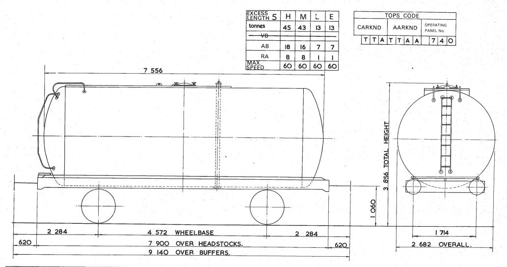
TARE - 13450kg CARRYING CAPACITY - 32<sup>500kg</sup> CAPACITY - 38 186 litres. MAX.SPEED - 60 mile/h. WHEELS - 952 DIA JOURNALS - 140 DIA. ROLLER BEARINGS.
