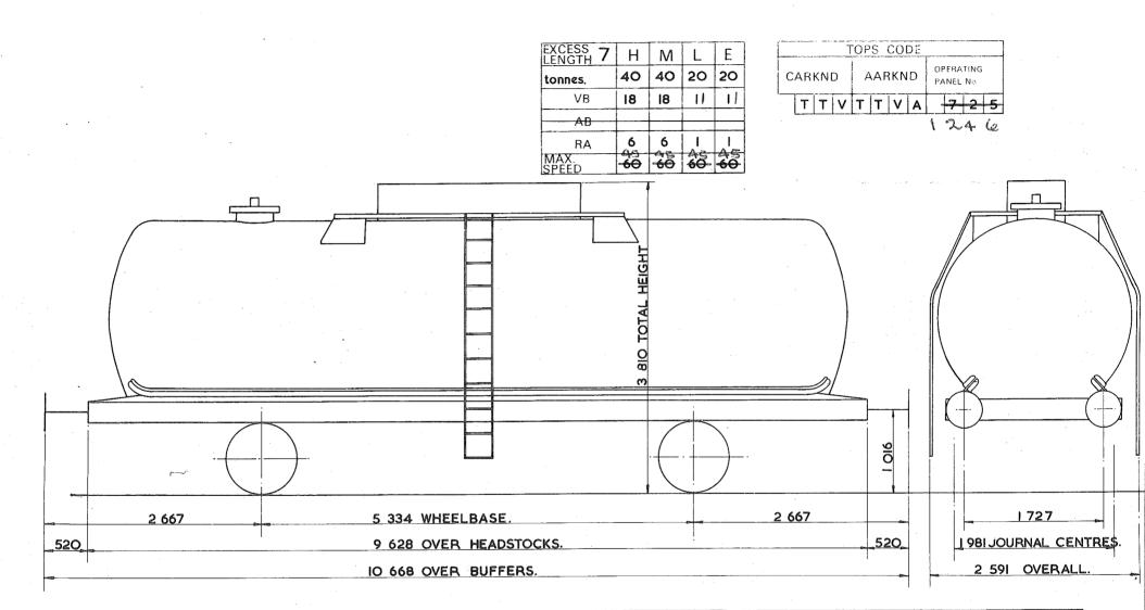
TARE-20000kg CARRYING CAPACITY-20000kg CAPACITY- 36.651m<sup>3</sup> MAX. SPEED-<del>SOMILE/h</del> WHEELS-952 DIA. JOURNALS-140 DIA. ROLLER BEARINGS.
