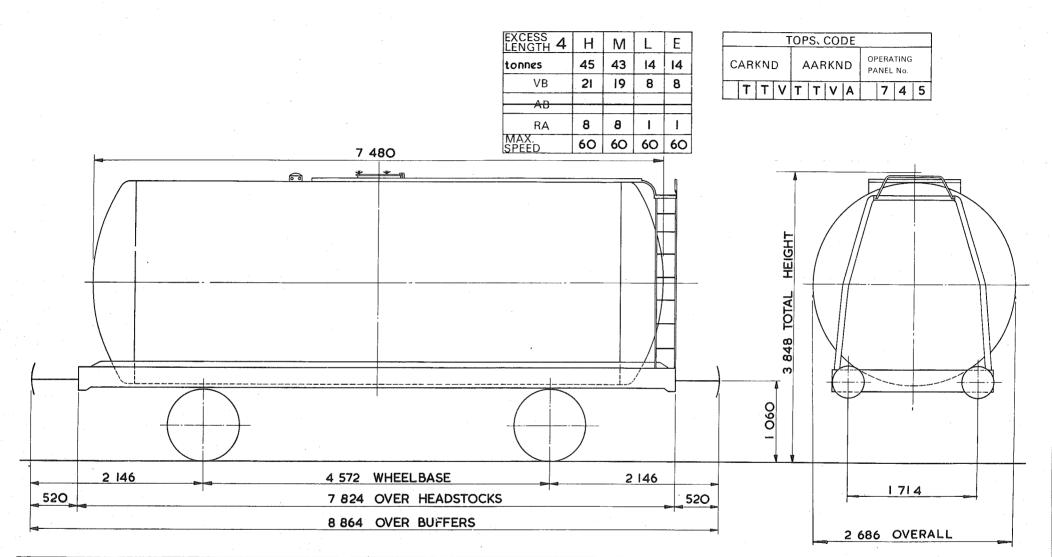
TARE - 13 300 kg CARRYING CAPACITY - 32 500 kg CAPACITY - 37854 litres - PETROL 38440 litres KERO-GAS CIL MAX. SPEED - 60 mile/h WHEELS - 952 DIA. JOURNALS - 140 DIA. ROLLER BEARINGS
