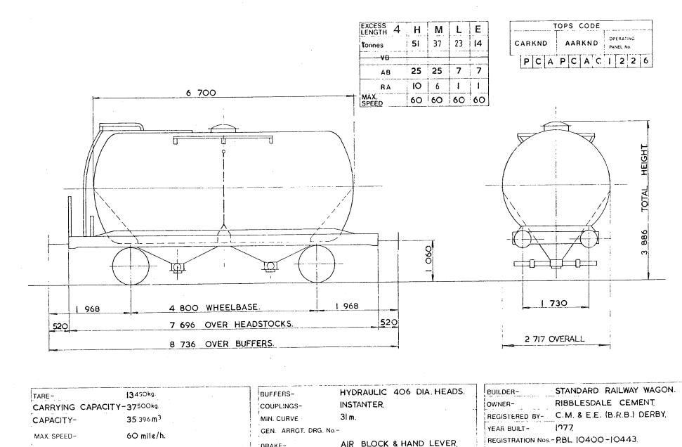
WHEELS- 952 DIA. BRAKE-JOURNALS- ISO DIA. ROLLER BEARINGS. SUSPENSION-
