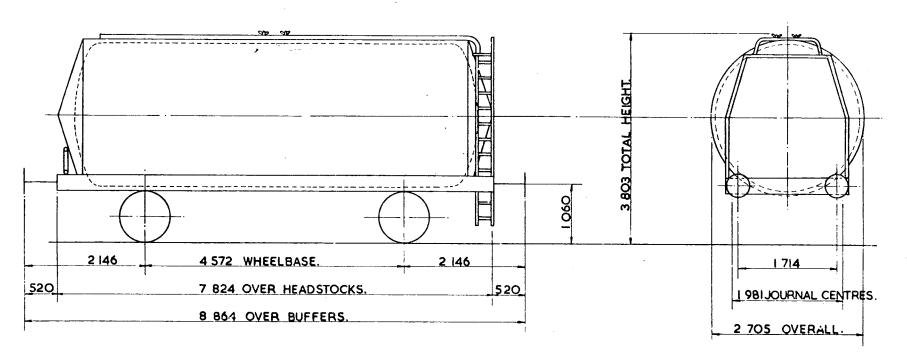
14000kg HYDRAULIC 406 DIA. HEADS. POWELL DUFFRYN. CARRYING CAPACITY-27000kg. INSTANTER SUKO CAPACITY-31022 litres. C.M.& E.E.(B.R.B) DERBY. 31m. 1963/1964. 60 mile/h. 50500 VACUUM BLOCK & HAND LEVER. 952 DIA. 140 DIA. ROLLER BEARINGS. EYE BOLT.
