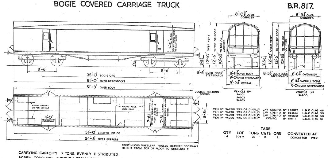
SCREW COUPLING. THROUGH STEAM PIPE. ELECTRIC LIGHT. VACUUM & OUTSIDE HAND BRAKE.
