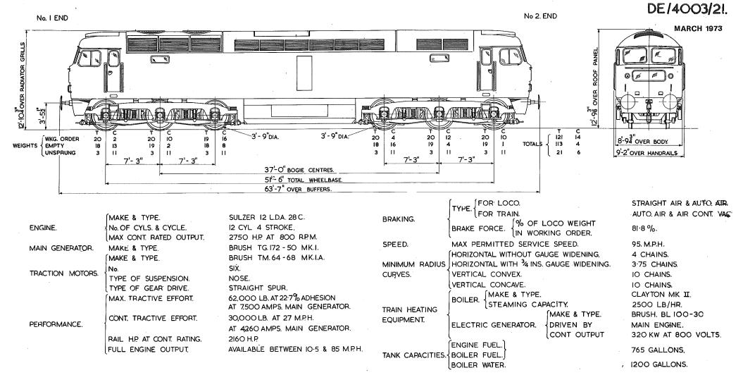
2750 H.P. BRUSH TYPE 4 C-C DIESEL ELECTRIC LOCOMOTIVE.
