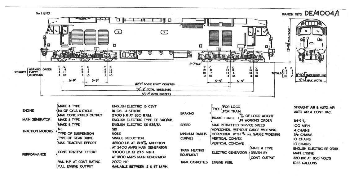
2700 H.P. E.E. Co. TYPE 4 C-C DIESEL ELECTRIC LOCOMOTIVE
